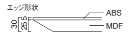
※裏面バックカー貼り TOP / メラミン化粧板 エッジ / ABS樹脂、MDF (塗装)
